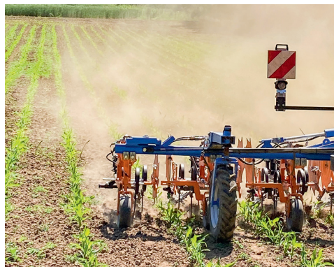
Kamerageführte Hacke im Einsatz im Maisbestand.
