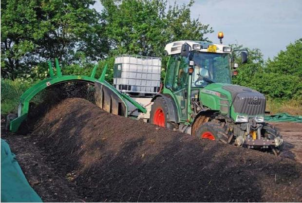
Abb. 4: Ein Kompostwender mit Bewässerungseinheit macht die effiziente und fachgerechte Kompostierung möglich
