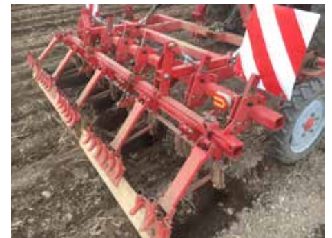
Abbildung 2: Abschleppen des Damms vor dem Auflaufen des Maiskornes
