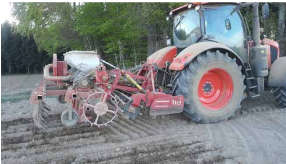
Abbildung 1: Maishäufelgerät mit Säggregaten und Grubberzinken. Bei Bedarf kann das Gerät mit einer Kreiselegge zur Saatbettbereitung kombiniert werden.
