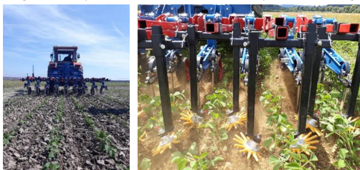
Abbildung 1: Beikrautregulierung mit der Scharhacke (links) und mit den zusätzlich installierten Fingerhacken (rechts).
