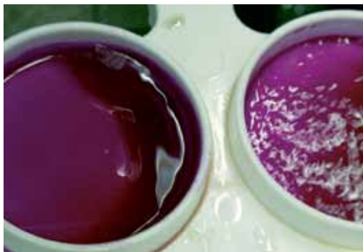
Test de Schalm – la comparaison directe révèle nettement les différences de consistance du lait.
